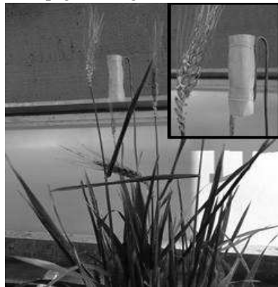
Figura 1. Cartão hidrossensível posicionado de forma a simular a morfologia de uma espiga de trigo. Passo Fundo-RS, 2017.
